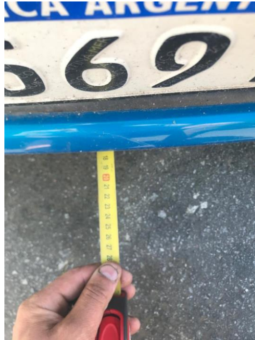
Posición en el centro del auto a 150 +/-20 mm
